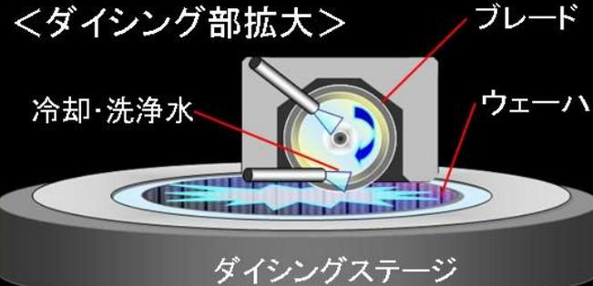
・冷却用の純水は絶縁体(電気を通さない)ため、純水の早い流れによる摩擦で静電気が発生する。この静電気がウェーハの製品を壊す(カミナリが落ちるようなもの)。対策としては純水にCO<sub>2</sub>(炭酸ガス)を強制的に混合して導電化する方法などが使われている。
