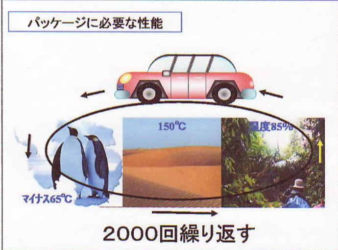
パッケージに必要な性能は、特に車載制御に使われる場合、人身に関係しているから過酷である。車は厳寒の地、灼熱の砂漠、高温多湿地帯で十数年使われるので、この条件で故障しないようなパッケージが必要となる。事前の半導体信頼性試験では、下記の条件で2000回繰り返しても故障しないように設計・製造する。車載以外に高い信頼性が必要とされるのは、医療関係の機器に使用する場合である。携帯電話やデジカメなど一般の家電製品は、車載のような信頼性は必要とされない。
